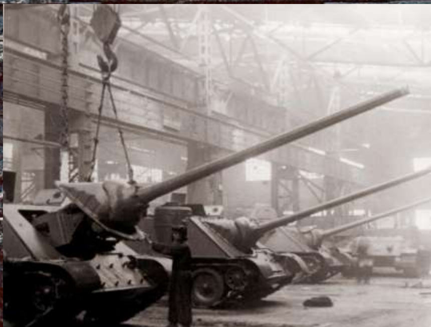
Монтаж на Уралмашзаводе пушки Д-10С в корпус САУ СУ-100
